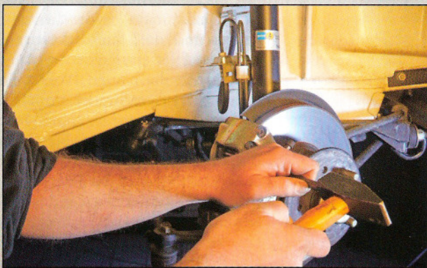
An der Vorderachse hat der BMW 02 Scheibenbremsen . Die Stärke der Beläge ist regelmäßig zu prüfen. Der Belagwechsel ist einfach
