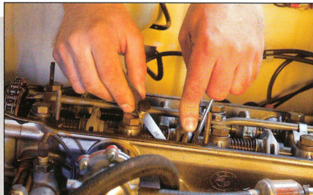
Ab und zu sollte man das Ventilspiel kontrollieren . Die Duplex-Steuerkette des BMW-Motors ist recht langlebig, ein Wechsel ist selten nötig
